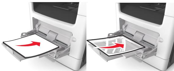
**注意：**当加载 A6 尺寸的纸张时，请确认多功能进纸器扩展板轻轻地靠着纸张的边缘，以便最后几张纸留在原位。
