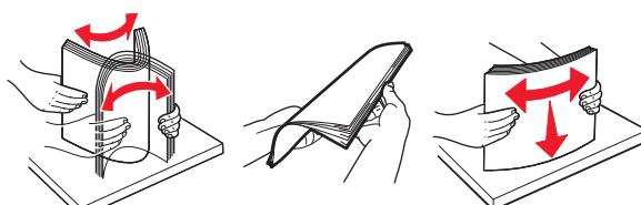
• 拿住透明胶片的边缘。前后弯曲透明胶片，使它们松散，然后将它们扇形展开。对齐透明胶片的边缘。
