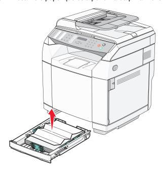
• Atolamentos atrás da área da bandeja — Localize o atolamento na superfície inferior do compartimento da bandeja. Poderá ser preciso acessar a parte de baixo da impressora para localizar o atolamento, como mostra a ilustração a seguir. Puxe o atolamento para fora em linha reta.
