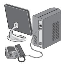
5 Conecte um terceiro cabo de telefone ao computador com modem e à porta EXT 🔳 da impressora.
