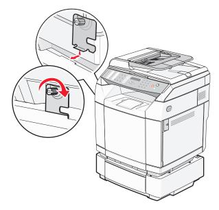
4 Começando na parte frontal da impressora, empurre a tampa lateral esquerda contra a impressora, encaixando cada slot da tampa sobre sua guia correspondente na gaveta a fim de cobrir o espaço entre a impressora e a gaveta.
