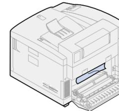
5 Drücken Sie die grünen Feststellhebel der Rolle zur Rückseite des Druckers.
