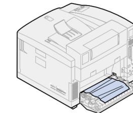
3 Überprüfen Sie das Innere des Papierfachs, und entfernen Sie das gestaute Papier aus dem Drucker.
