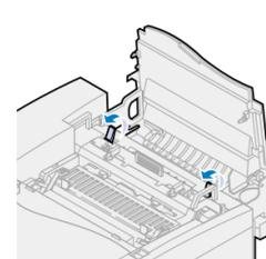
4 Schieben Sie die Entriegelung der oberen Klappe nach vorne, und heben Sie die obere Klappe an.
