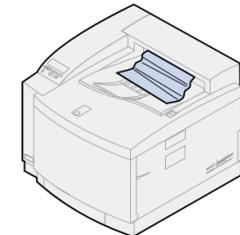
2 Tire del pestillo de liberación de la puerta posterior hacia la parte posterior de la impresora.
