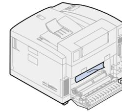
4 Deslice el pestillo de liberación de la puerta superior hacia la parte frontal de la impresora y levante la puerta superior.
