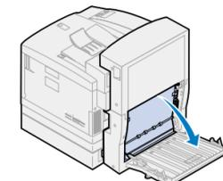
4 Levante el panel de acceso interno del dúplex posterior.
