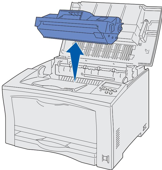
**4** Trekk opp låsene på hver side av fikseringsenheten slik at den frigjøres.
